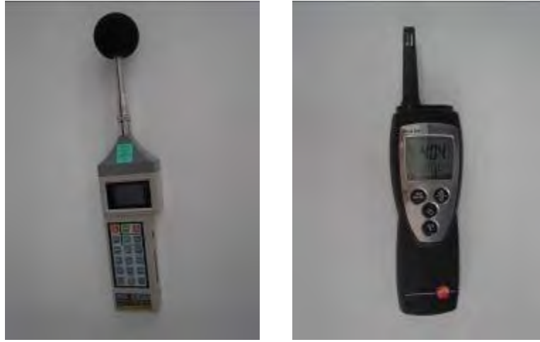
Şekil 2. Delta OHM-HD 9020 gürültü ölçme cihazı (solda) ve testo625 higrometre cihazı (sağda)
